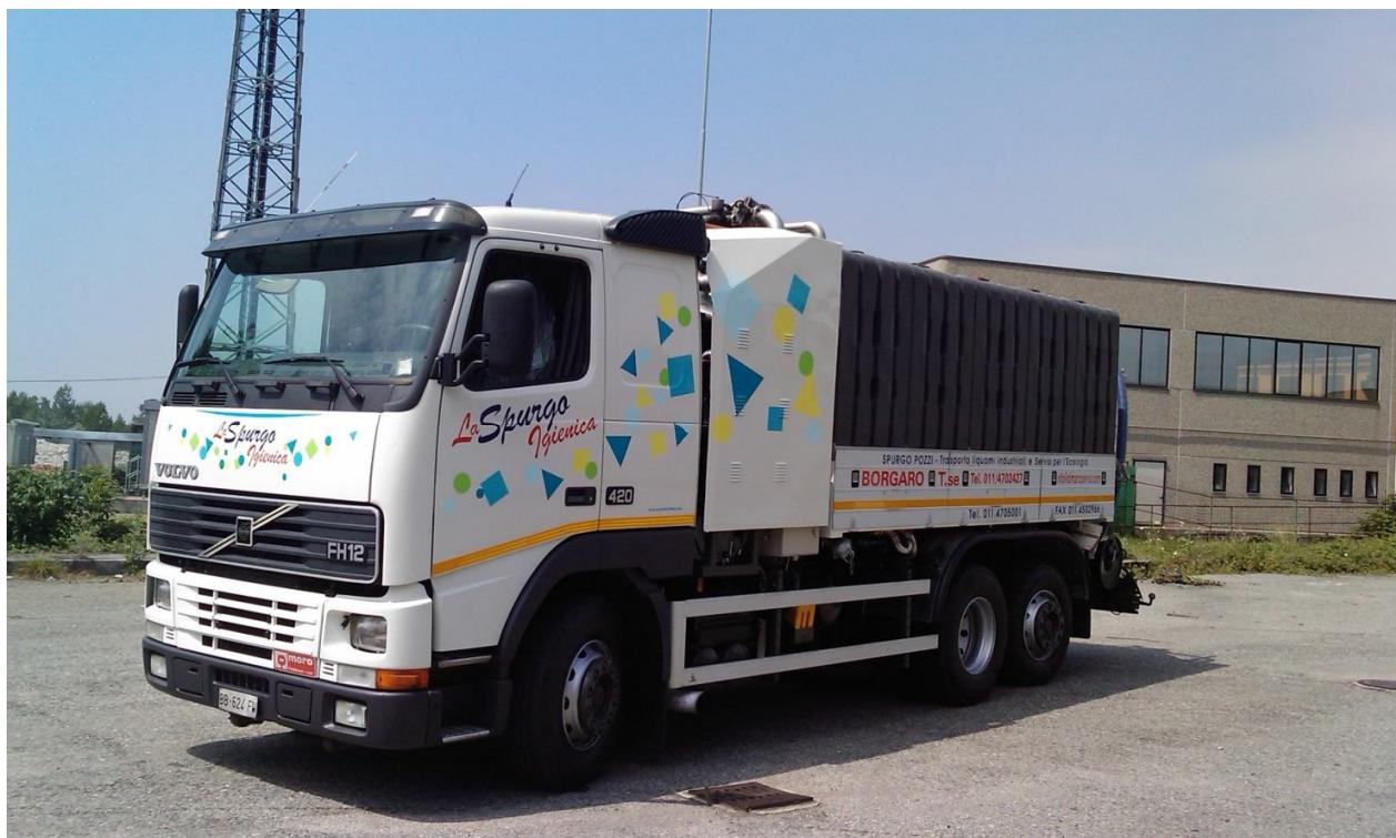
Pulizia fognature con il sistema di riciclaggio dell'acqua mediante l'aspirazione della medesima, compreso i fanghi nel servizio e con un sistema di filtraggio e separazione avviene il riciclo ed il riutilizzo dell'acqua, separando solidi dall'acqua di fogna. L'acqua filtrata è convogliata direttamente. Riducendo il peso corporeo e tagli di pulizia e spesa di manutenzione rispetto ad altre autobotti Canal Jet. Affidabile nelle condizioni più difficili.
